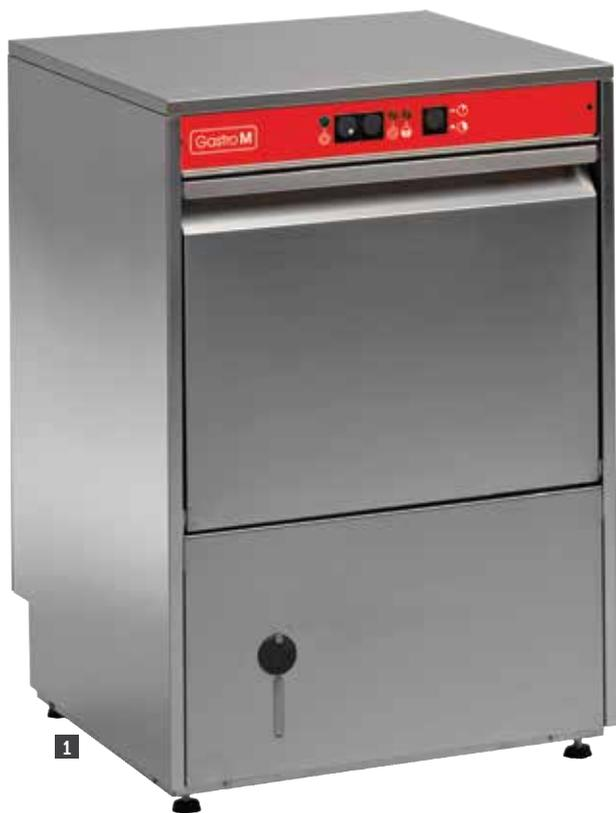
Lave-verres et tasses GW35 et GW41 Gastro-M en acier inox 18/10 AISI 304 double paroi, commandes analogiques, 2 cycles de lavage 20/30 casiers/h. Avec cuve emboutie et bras de lavage et rinçage inox et indépendants. Thermostop et doseur de produit de rinçage intégrés. Livrés avec 2 paniers à verres. Vidange par gravité (la machine doit être surélevée par rapport à la vidange). Une pompe de vidange peut être achetée séparément (code AG407).
