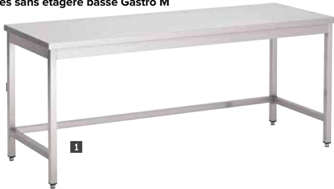
Tablette supérieure en inox AISI 430 avec bords tombants de 40 mm, renforcée par de l'aggloméré mélaminé de 18 mm caché par une tôle collée en acier galvanisé. Pieds en tubes carrés de 40 mm reliés entre eux par des profilés en inox et posés sur des embouts réglables de 65 mm en inox. Renforcée à l'arrière et latéralement par des tubes carrés de 35 mm. Avec ou sans dossier.
