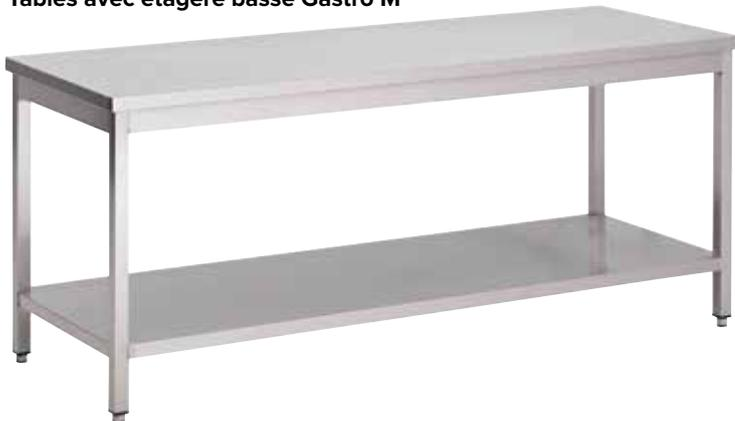
Tables en inox AISI 430 avec bords tombants de 40 mm et renforcée par de l'aggloméré mélaminé de 18mm caché par une tôle collée en acier galvanisé. Pieds en tubes carrés de 40mm reliés entre eux par des profilés en inox et posés sur des embouts réglables de 65mm en inox. Tables sans dossier, profondeur 60cm ou 70cm.
