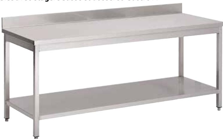
Tables en inox AISI 430 avec bords tombants de 40 mm et renforcée par de l'aggloméré mélaminé de 18mm caché par une tôle collée en acier galvanisé. Pieds en tubes carrés de 40mm reliés entre eux par des profilés en inox et posés sur des embouts réglables de 65mm en inox. Tables avec dossier, profondeur 60cm ou 70cm.
